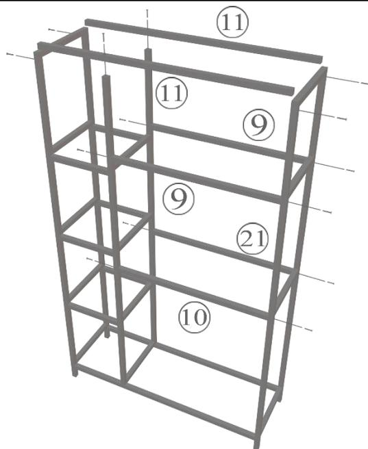
Винтами 30мм (14 шт.) закрепить профили 860мм (деталь 11) и профили 600мм (деталь 9, 10, 21). Деталь 10 расположить боковыми отверстиями в сторону рабочего места (ближними к краю отверстиями в сторону задней стены). Для зеркальной сборки поменять местами детали 10 и 21.
