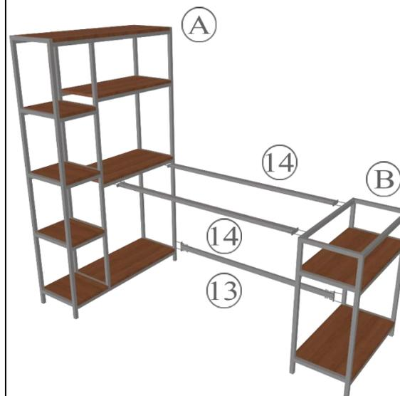
Винтами 10мм (12 шт.) закрепить профили 1090мм (деталь 13, 14) между конструкциями «А» и «В».
