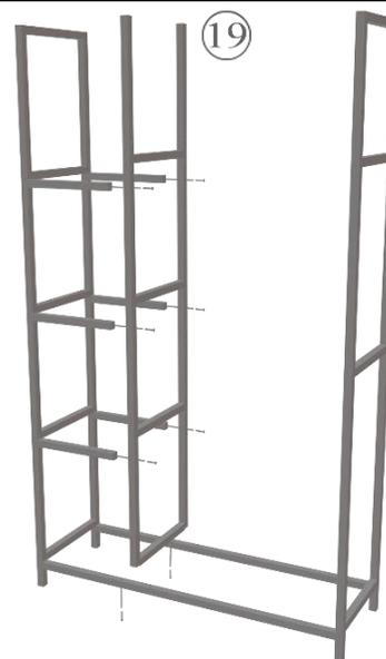
Винтами 30мм (8 шт.) закрепить раму 1400мм (деталь 19).
