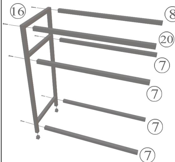
Винтами 30мм (6 шт.) закрепить профили 570мм (деталь 7, 8, 20) на раме каркаса 710мм (деталь 16). Деталь 8 расположить боковыми отверстиями в сторону рабочего места (отверстие на расстоянии 60мм должно быть со стороны задней стены). Для зеркальной сборки поменять местами детали 8 и 20. В зависимости от комплектации вставить ножки-заглушки, при необходимости, вставить мебельные ножки.
