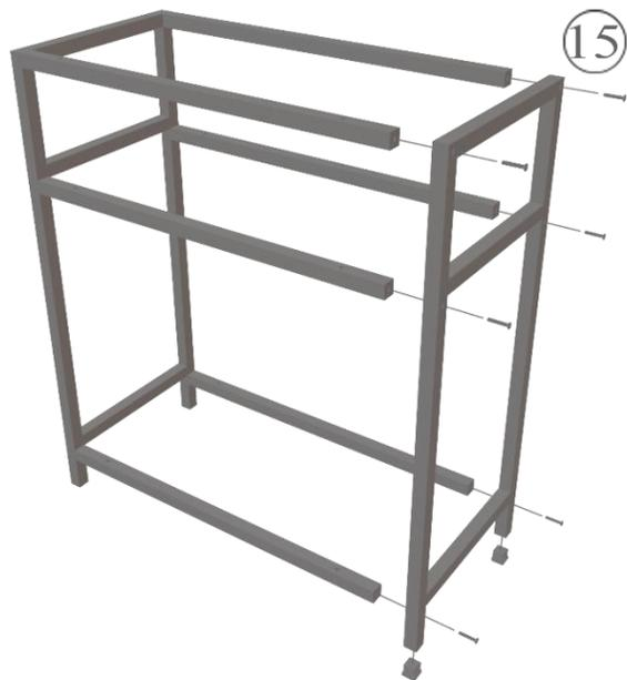
Винтами 30мм (6 шт.) закрепить раму каркаса (деталь 15).
