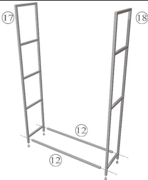
Винтами 30мм (4 шт.) закрепить перекладины 860мм (деталь 12) между рамами каркаса 1500мм (деталь 17, 18). Раму 18 расположить боковыми отверстиями в сторону рабочего места.
