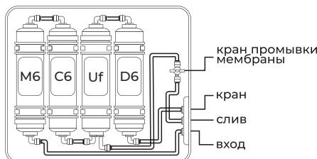
Независимо от комбинации картриджей, процесс фильтрации должен проходить строго в таком порядке!
