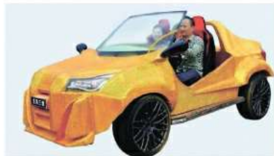
Рис. 219. Первый в мире автомобиль, созданный в Китае на 3D-принтере. Для этого потребовалось 5 дней и 1000 долларов
