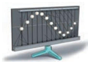
173-сурет. Көлденең және бойлық толқындарды бақылауға арналған толқындық мәшине
