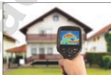
197-сурет. Тепловизорды қолдану арқылы тұрғын үйдің жылу шығынын зерттеу
