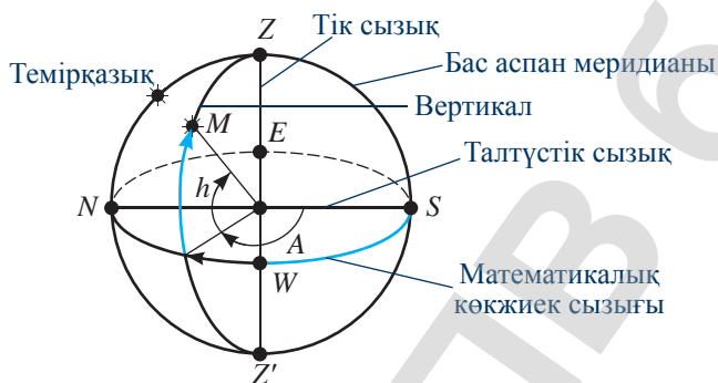
68-сурет. Жұлдыздарды бақылау үшін қажетті горизонталь координаталар жүйесі
