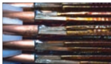
Рис. 123. Сверхпроводящие кабели, разработанные в лаборатории ЦЕРН
