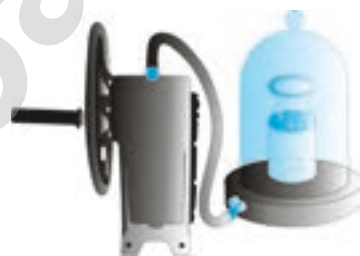
Рис. 47. Закипание воды при комнатной температуре
