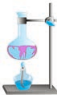
Рис. 12. Движение конвекционных потоков
