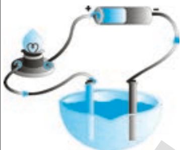
Рис. 132. Раствор электролита проводит электрический ток
