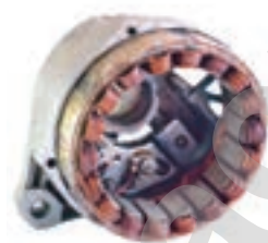
Рис. 172. Внешняя обмотка генератора – якорь
