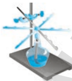
Рис. 9. Различия теплопроводности металлов
