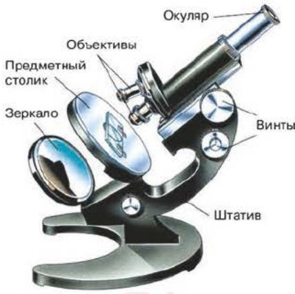
Рис. 7. Микроскоп
