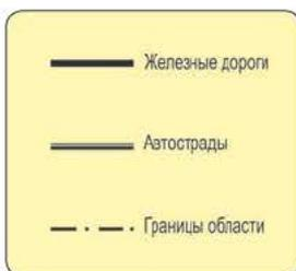
**Линейными** условными знаками изображают объекты местности, имеющие значительную протяженность и небольшую ширину. Такими объектами являются автомобильные дороги, железнодорожные магистрали, трубопроводы, линии связи и линии электропередачи.
